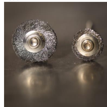
Figuur 6 Staalborstel. Kies voor de borstels van het merk zelf. Die gaan veel langer mee en de draadjes komen niet los tijdens het frezen. Rechts een nagenoeg opgebruikt borsteltje. Gooi die niet weg. Je kan er groeven en dergelijke mee verfijnen.
